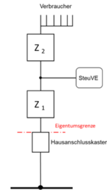
Abbildung 15 - Messkonzept für Modul 2 mit Kaskade (ohne Erzeugung)
